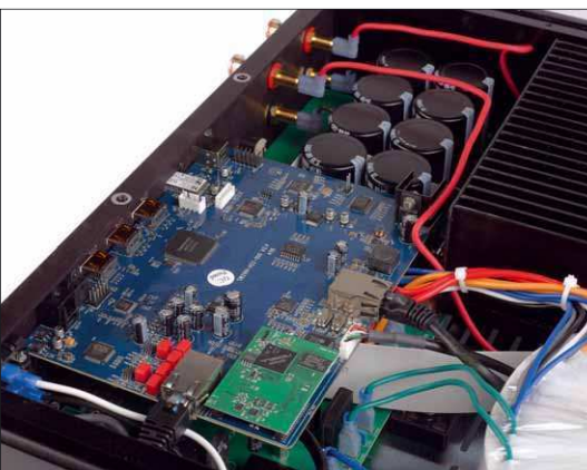
Das digitale Audioboard verleiht dem Verstärker eine enorme Vielseitigkeit
